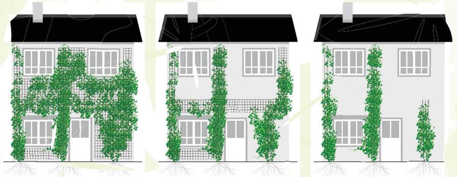
▲ Beispiele für Kletterhilfen. Von Links: flächige Gitter-Konstruktion, partielle Gitter-Konstruktion, partielle Seilkonstruktion.
