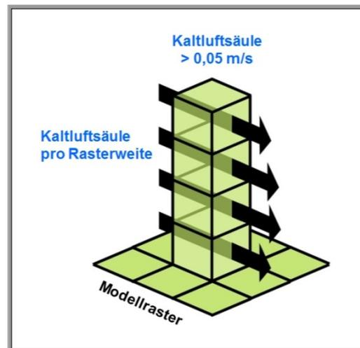
Abb. 12: Prinzipskizze Kaltluftvolumenstrom
