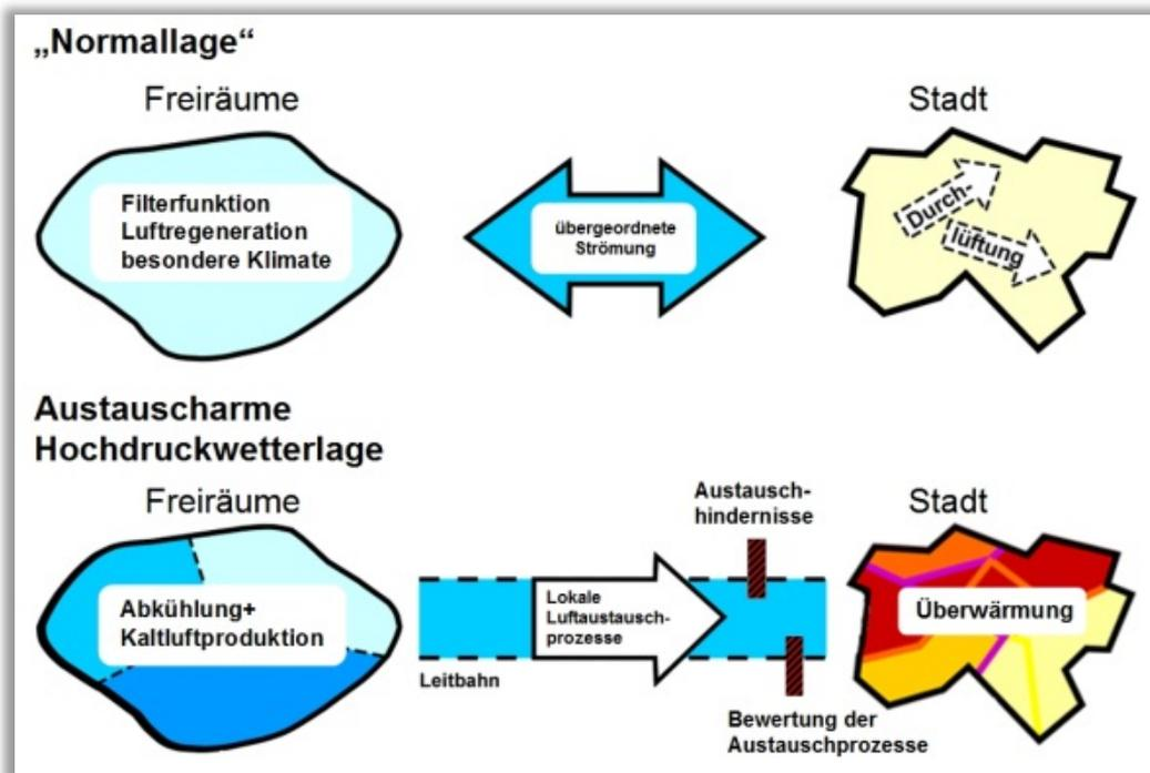
Abb. 2: Prozessorientierte Analyse bei einer austauscharmen Hochdruckwetterlage
