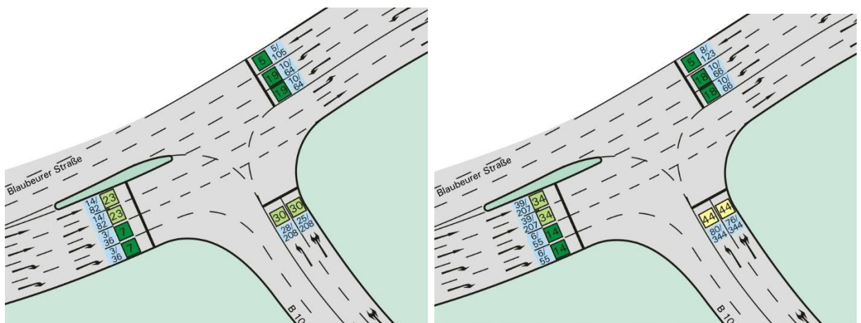
Abb. 6 Verkehrsqualitäten, Wartezeiten und Rückstaulängen am westlichen Teilknotenpunkt (Variante 2), Spitzenstunde morgens (links) und nachmittags (rechts) (Legende s. Tab. 1)
