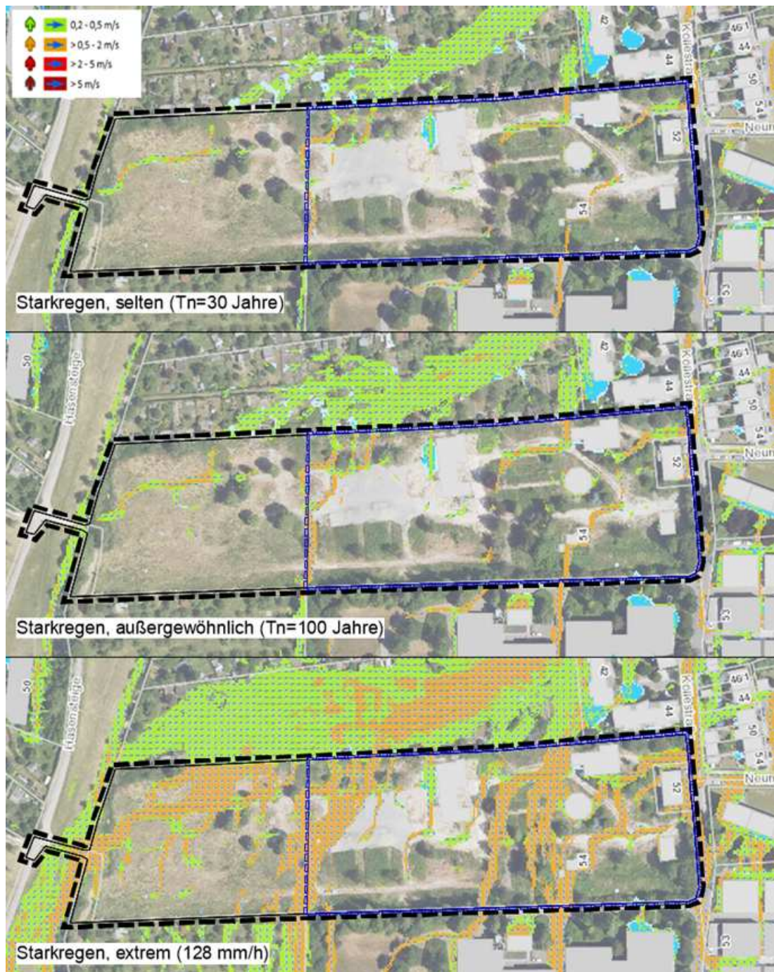
Abbildung 8: Kommunale Starkregengefahrenkarte Gebiet Stadt Ulm, Überflutungsflächen, Fließgeschwindigkeit und Fließrichtung (LUBW Daten und Kartendienst, unmaßstäblich)
